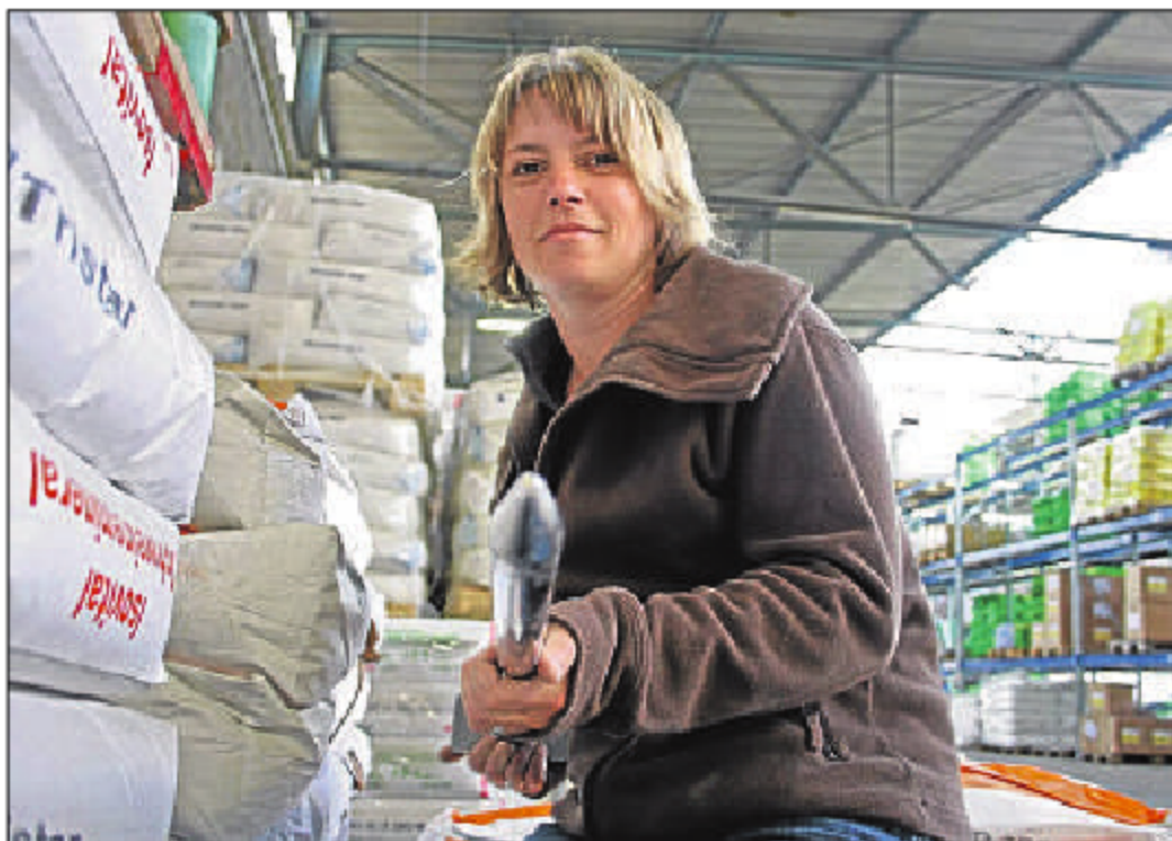
Ein Stich für die Probe: Regina Keller vom Landesbetrieb Landwirtschaft in Fritzlar entnimmt mit einem Metallstab Futtermittel aus Säcken, das anschließend im Labor untersucht wird. Fotos: Schleichert
