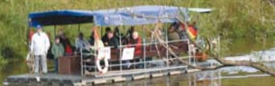
Die beiden je 24 qm großen Flöße bestehen aus Jetfloat-Schwimmelementen und verfügen über einen durch eine Reling gesicherten Fahrgastbereich mit Sitzbänken. Eine Markise, die natürlich auch eingerollt werden kann, dient bei jeder Witterung als ideales „Dach“. Jedes Floß wird von zwei erfahrenen Flößern gesteuert bzw. begleitet. Die Fortbewegung erfolgt hauptsächlich durch die Wasserkraft, nur an einigen Stellen muss mit Hilfe eines Motors korrigiert werden.
