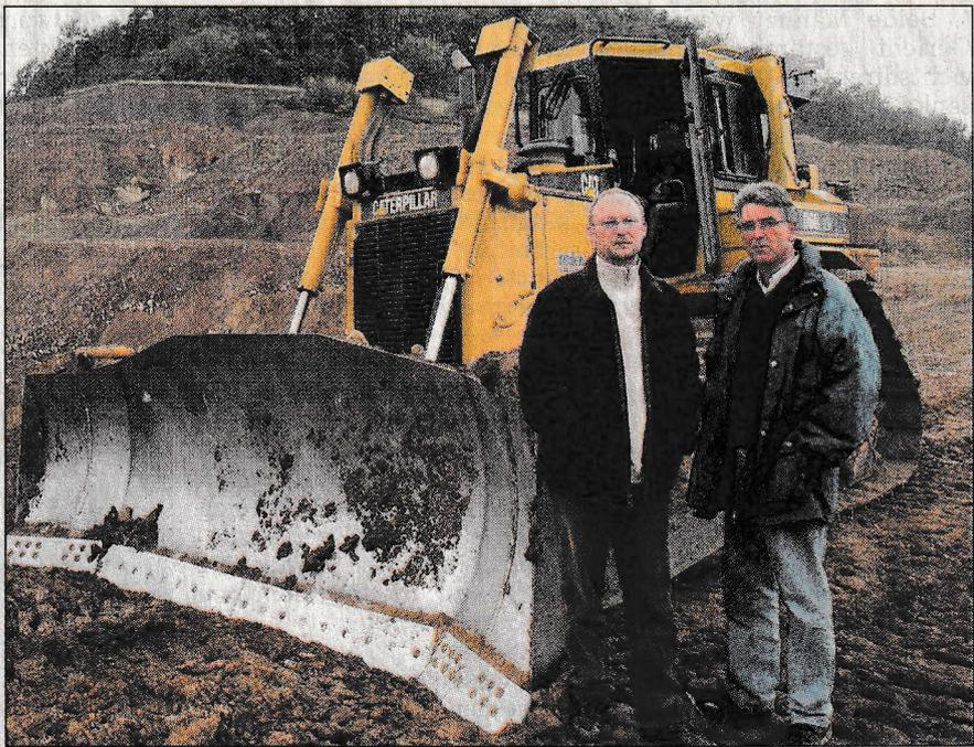
**Millimeterarbeit:** Dank GPS-Ausrüstung formen die Planierschilder der Caterpillar-Raupen das Gelände quasi selbstständig. Raupenfahrer Toni Giesen fährt und lenkt die Baumaschine. Im Vordergrund Knauf-Betriebsleiter Meinhard Puhl (rechts) und Martin Sobotta von der Dorstener Spezialfirma Suden.
