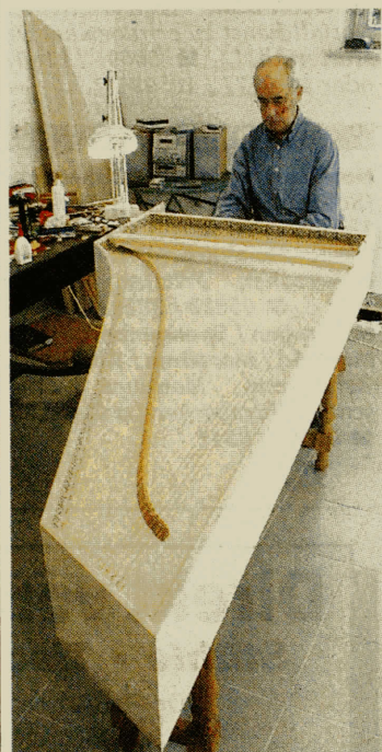
ROHBAU: Im Wesentlichen ist das Cembalo fertig. Was fehlt, sind das Präparieren, Beizen und Lackieren der Holzteile.
