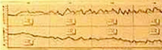
Diagramm der Temperatur- und Luftfeuchtigkeitsschwankungen im Mauerwerk des Klosters Heydau
